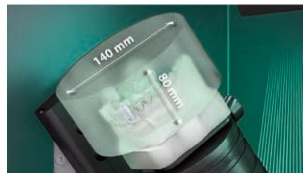
Accurate scansione superficie con una precisione di misura\* inferiore a 9 micron nel solido è possibile con lo scanner Zfx™ Evolution plus.
