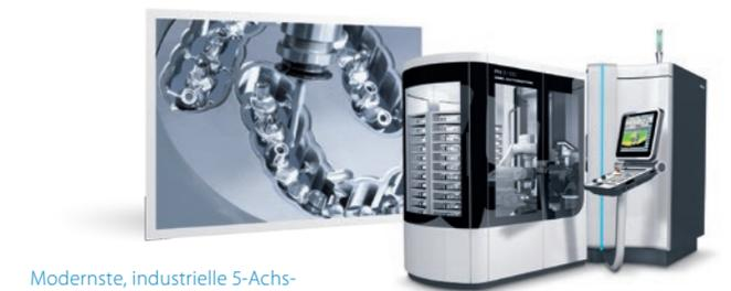
Modernste, industrielle 5-Achs-Fräszenter mit Roboter-Automation.
