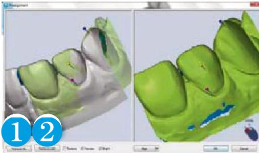
Para identificar tres posiciones de marcador idénticas en ambos conjuntos de datos es conveniente elegir una Vista similar para los conjuntos de datos. Las vistas de ambos conjuntos de datos se pueden girar, ampliar/reducir y mover con el ratón, como se describe en → apdo. 5.2 "Comandos con botones del ratón y con el keypad" y se pueden colocar en una posición idéntica.
