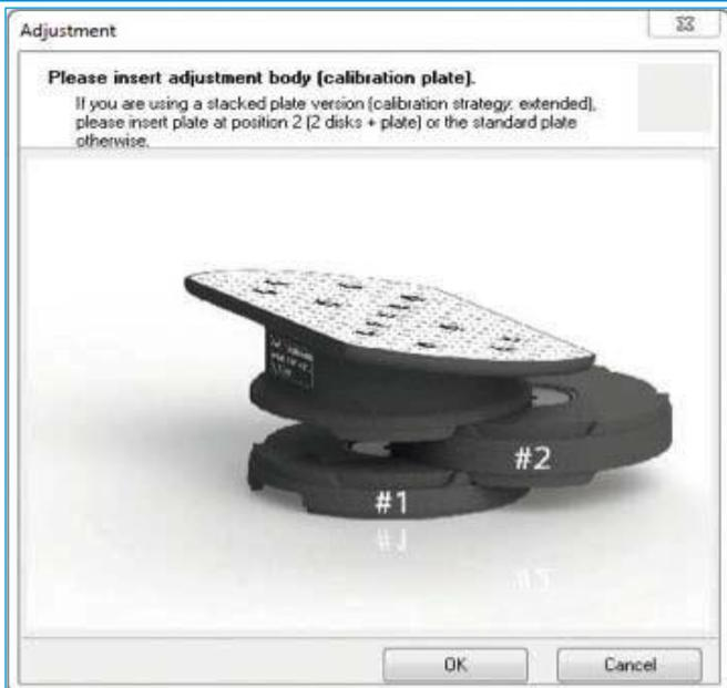
Posicione la Placa de calibración junto con la Placa espaciadora (Nº 2) y la Placa base (Nº 1) en la unidad rotativa y pivotante.
