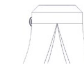
1b. Bloc en vitrocéramique muni d'un connecteur de serrage standard 10 x 10 mm
