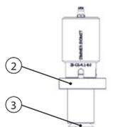
**Step 3:** Serrare la vite di fissaggio (3) nella porzione filettata del grezzo per abutment prefresato (2)
