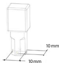
1b. Sistema di serraggio 10x10 mm standard di un blocco in vetroceramica
