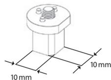
1a. Sistema di serraggio 10x10 mm per adattatore di grezzo per abutment prefresato Zfx™
