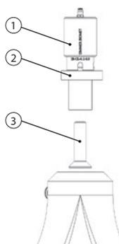
**Step 1:** Svitare la vite di fissaggio (3) dall'adattatore (2)
