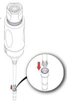
**Step 6:** Avvitare la vite girando il manipolo dinamometrico Zfx™ verso destra. La coppia preimpostata si raggiunge non appena è percettibile una sovrapposizione dell'impugnatura.
