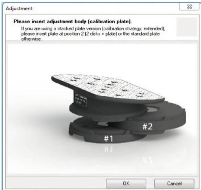
Posizionare la piastra di calibrazione con la piastra di montaggio (# 1) e la piastra distanziatrice (# 2) sull'unità girevole rotante.
